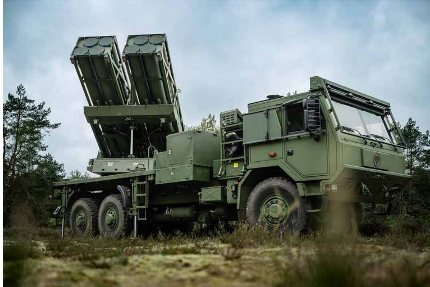
Met het PULS raketartilleriesysteem kunnen heel precies en heel ver in de diepte doelen worden aangegrepen. Het systeem is modulair; Defensie plaatst het op een Scania. (Foto: MCD/Wessel Zuiderduin)
